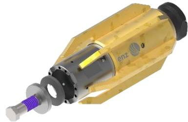
11. Die Auflageflächen des Fräskopfes und der Nabe reinigen und den Fräskopf aufsetzen. Anschließend die Zylinderschrauben mit Loctite 243 (Art. Nr. C192) bestreichen und einschrauben.
