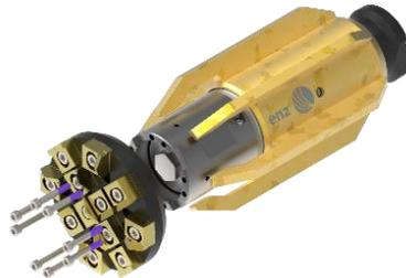
12. Die Zylinderschrauben mit einem Drehmomentschlüssel auf **12 Nm** festziehen. Den Klebstoff mindestens 24 h trocknen lassen!
