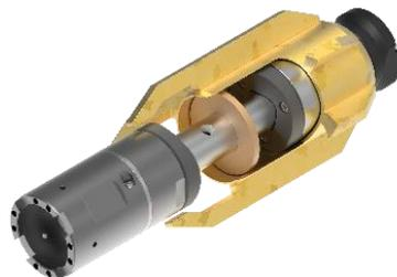
5. Anstelle der beiden Tellerfedern die kleinere von beiden Distanzscheiben (Art. Nr. 14.D) montieren. Anschliessend die Zentrumschraube mit Loctite 243 (C192) bestreichen und mit **180 Nm** anziehen.
