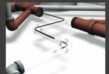
Die JetCam windet sich problemlos durch Kurven, Abzweigungen oder T-Anschlüsse. Auch Fallstränge können so befahren werden.
