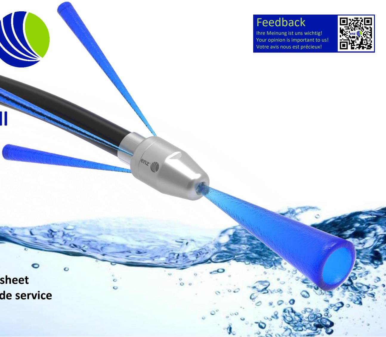
Dank seinem scharfen, rotierenden Frontstrahl fräst sich der Rotodrill in einem Arbeitsgang durch die Verstopfung. Gleichzeitig schiebt der grösste Teil der zur Verfügung stehenden Wassermenge den Rotodrill vorwärts und transportiert den Schmutz aus dem Rohr.
