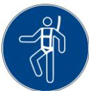
Ceinture de sauvetage ou vêtement de sécurité avec boucle cousue dans le cou. Pendant le sauvetage, la ceinture de sauvetage est accrochée dans la boucle du cou. La victime est soulevée, par exemple, par le biais d'un treuil de sauvetage avec un dispositif automatique d'arrêt de la charge.
