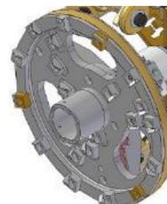
6. Enduisez de Loctite 243 (C192) les filetages des six vis à six pans creux. Serrez ensuite ces vis à un couple de serrage de 50 Nm.
