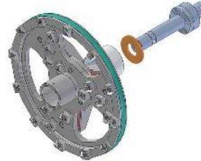
6. Montieren Sie die kleine Distanzscheibe und den Deckel.
