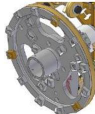
6. Bestreichen Sie die Gewinde der sechs Innensechskantschrauben mit Loctite 243 (C192). Ziehen Sie diese danach mit einem Anziehdrehmoment von 50 Nm an.
